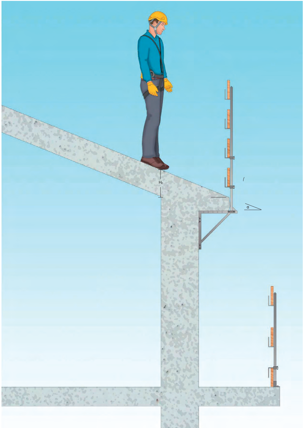
Figura 4 - Parapetti provvisori divisi per classi di utilizzo
