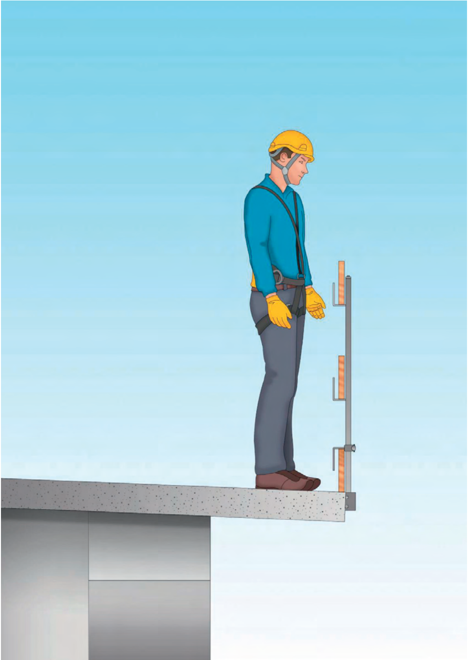
Figura 5 - Parapetto provvisorio montato su soletta di calcestruzzo armato
